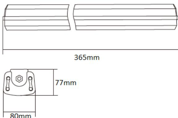
*Der hochwertige Aluminiumkörper bietet eine hervorragende Wärmeableitung.*
